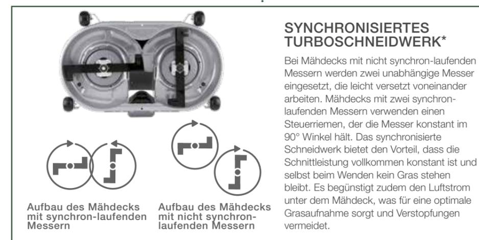
Aufbau des Mähdecks mit synchron-laufenden Messern
